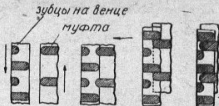
Рис. 6. Схема действия муфты переключения
